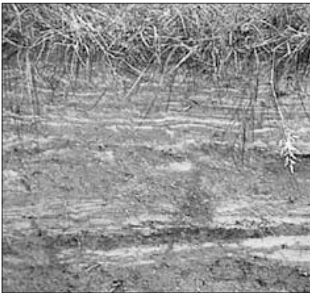
Fig. 23 : Sol sableux (alluvial) à l'état naturel. La stratification des sables plus grossiers ou plus fins, résultant des épisodes successifs de déposition, est nettement reconnaissable.
