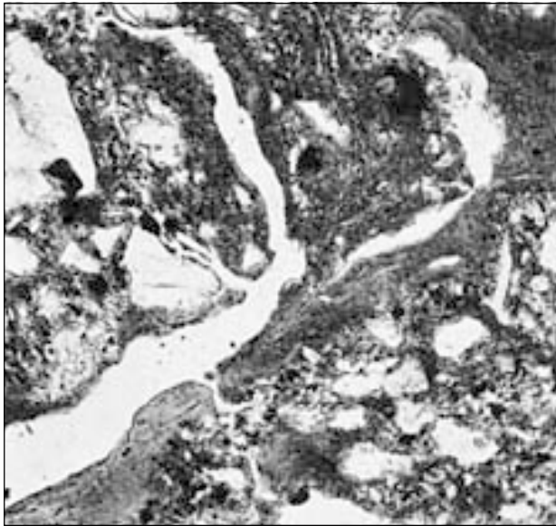
Fig. 33 : Lame mince d'un grumeau en lumière incidente sous microscope. Les espaces poreux apparaissent en blanc.
