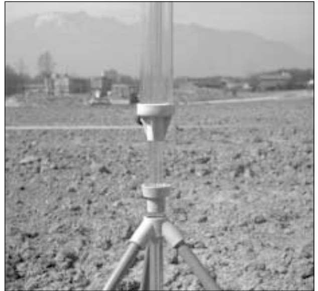
Fig. 45 : Contrôle de la perméabilité d'un rehaussement de terrain important à l'occasion d'une campagne de terrain de l'IATE/EPFL (Al Carcale 1994) près de Gordola (TI).
