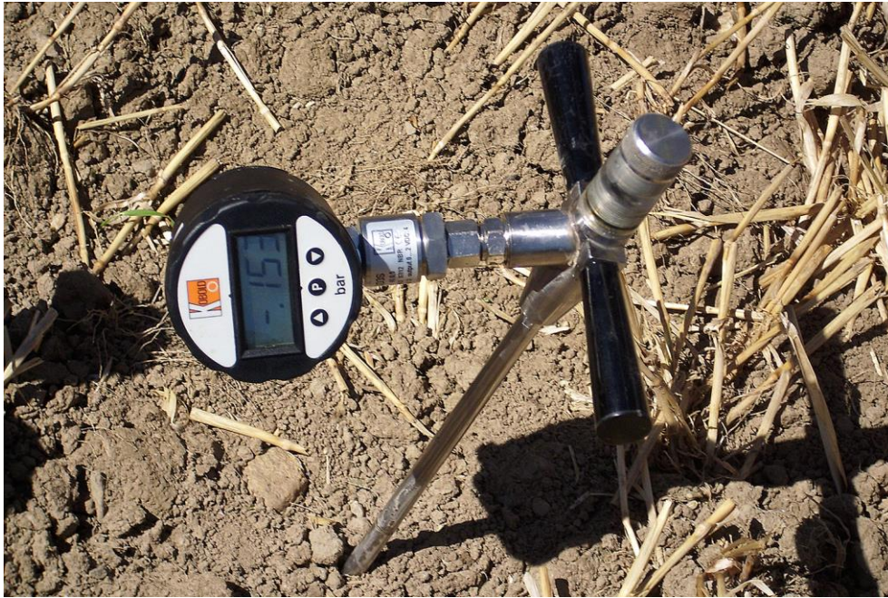
Fig. 24 > Tensiomètres mobiles à réponse rapide
