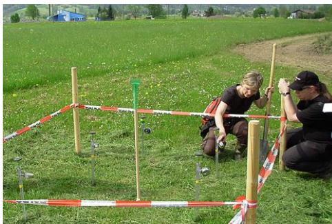
Fig. 25 > Placette de cinq tensiomètres sur chantier
