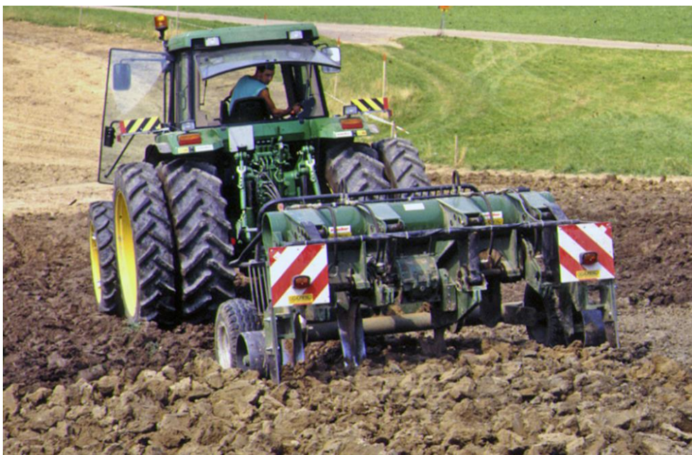
Fig. 40 &gt; Décompactage avec une bêcheuse
