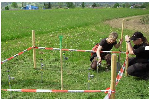
Fig. 25 > Placette de cinq tensiomètres sur chantier
