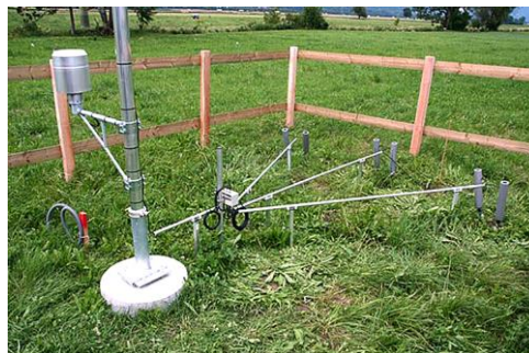
Fig. 25 > Placette de cinq tensiomètres sur chantier
