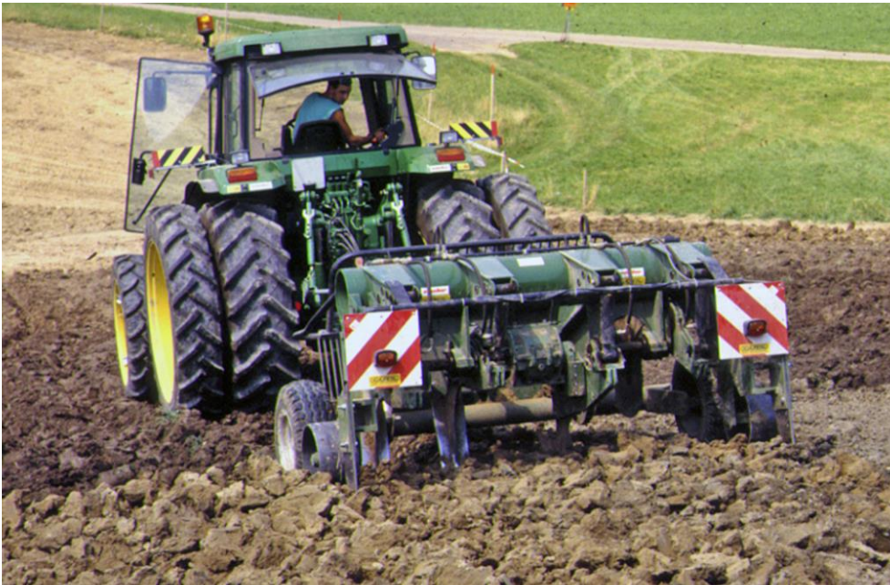
Fig. 40 &gt; Décompactage avec une bêcheuse
