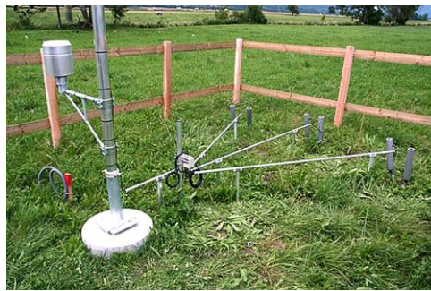
Fig. 25 > Placette de cinq tensiomètres sur chantier
