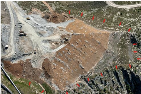
Photographie aérienne de la crête en été 2012 avec la limite du dépôt de matériaux (flèche rouge), la partie enherbée en 2012 (surface verte ou grise en aval), et les surfaces renaturées et remises en état en 2012 (couleur brun clair).
