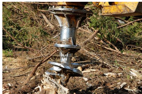
Détail de la vis tire-bouchon
